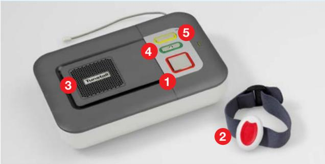
Ein Druck auf die **Notfalltaste 1** oder den **Funksender 2** baut eine direkte Verbindung zur rund um die Uhr besetzten Hausnotrufzentrale auf. Das Gespräch erfolgt über eine integrierte **Freisprecheinrichtung 3**.
